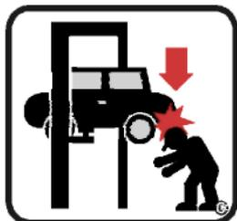
**НЕ СТОЙТЕ ПОД НАХОДЯЩИМСЯ НА РАБОТАЮЩЕМ ПОДЪЕМНИКЕ АВТОМОБИЛЕМ.**
